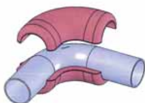
Positionnement du manchon prémoulé sur la tuyauterie au niveau de la fuite.
