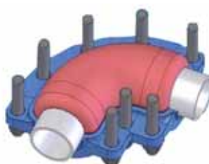
Mise en place d'une demi-partie de la boîte par-dessus le manchon prémoulé.
