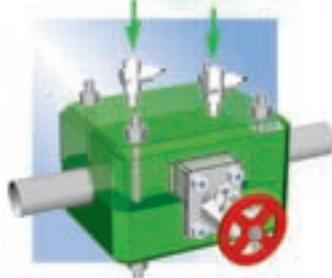
Intervention sur tuyauterie ou sur appareil par pose d'une boîte injectée
