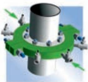
Intervention sur assemblage boulonné par pose d'un collier à ailes et injection
