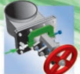
Intervention sur presse-étoupe de vanne par pose d'un serre-à-vis et injection
