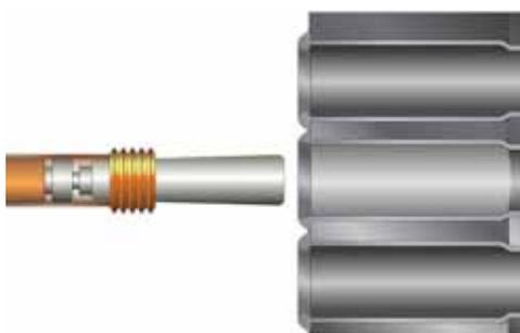
Mise en place de l'obturateur dans le tube
