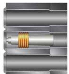
Sertissage des canelures de la bague puis rupture de la tige cassante
